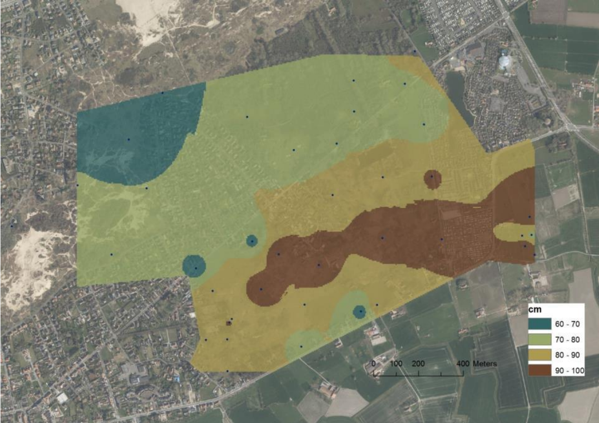
Fig. 4.3.18. Jaarlijkse schommeling van het grondwater op basis van gegevens uit 2015-2016.
