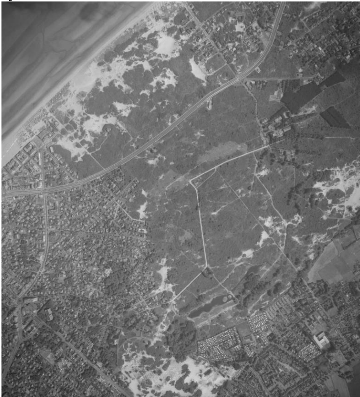
Fig.4.1.17. Luchtfoto 2004 (S2-A 998). In het zuiden van het projectgebied zijn de infiltratiepanden van de IWVA zichtbaar. Ze worden gebruikt voor een kunstmatige aanvulling van grondwater en de daaropvolgende winning van het infiltratiewater in de waterwinning van St. André. Het grootste deel van het duinengebied is ondertussen verstruweeld of met bos bezet. Alleen in de Schipgatduinen, rond de Hoge Blekker en in het zuidoostelijk deel van de Doornpanne (IWVA&ANB eigendom) is nog een aanzienlijke oppervlakte duin niet of slechts schaars begroeid.
