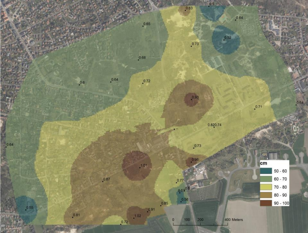
Fig. 4.3.10 Jaarlijkse schommeling van het grondwater op basis van gegevens uit 2015-2016).
