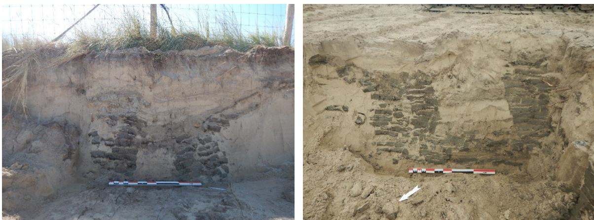
Fig. 138. Twee gecoupeerde loopgraafsegmenten. De opbouw in kleiplaggen is duidelijk te zien.
