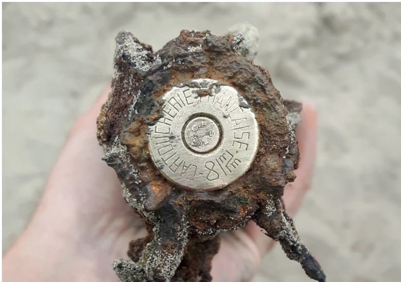
Fig. 164. Het staartstuk van de mortier, met daarin de cartouche. Opschrift: 'CARTOUCHERIE FRANCAISE 81 mm'. Op het slaghoedje staat 'C.F. PARIS'.
