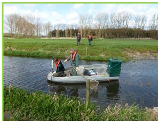
Figuur 2. Elektrische afvissing vanuit een boot van de Hoofdsloot stroomop het pompemaal (locatie 1a).
