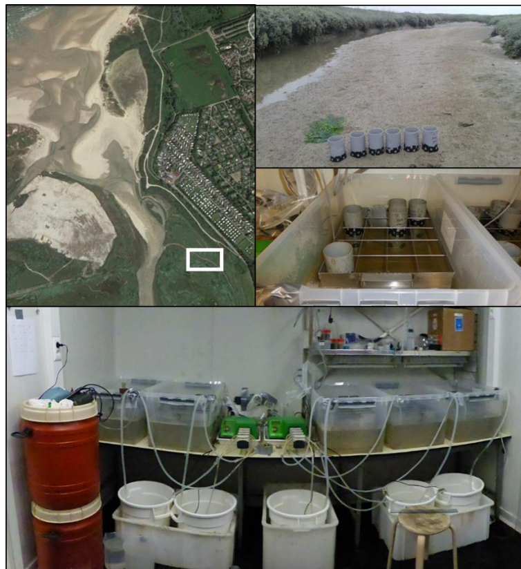
Figuur 1. Staalnamelocatie (rechthoek), experimentele eenheden en opstelling van de laboratoriumproef.
